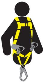
*Los ganchos chicos se colocan en las anillas de la cadera del arnés; el gancho grande se asegura a un anclaje, permitiendo trabajos de sujeción o posicionamiento.*
